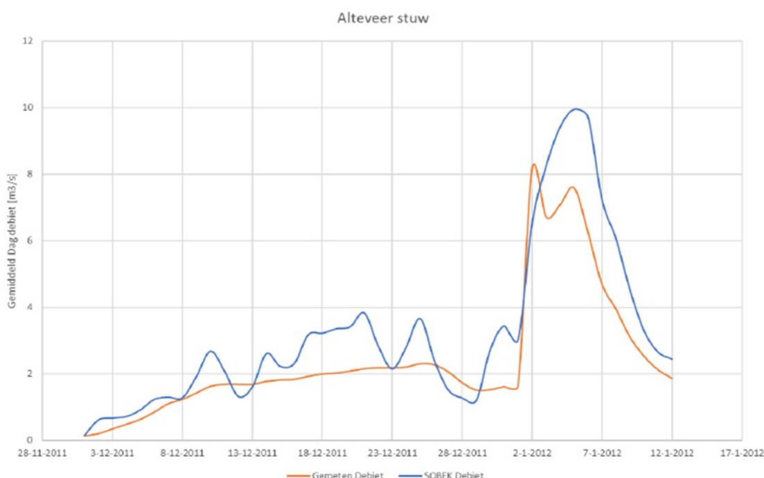
Figuur 1: Gemeten en berekende afvoer Alteveerstuw.
