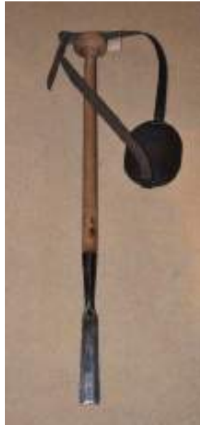
Prikstokken voor vastzetten stromatten op zeedijk
