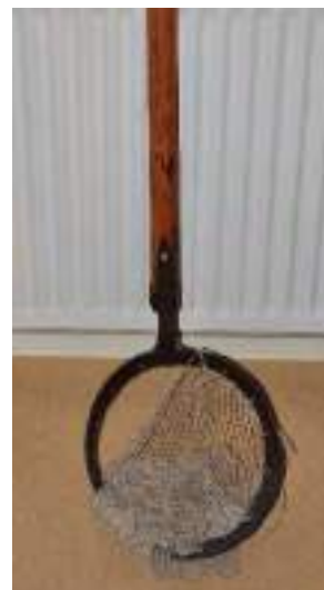
Beugel voor baggeren sluis
