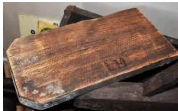
Planken gebruikt voor kruiwagens bij dijkaanleg
