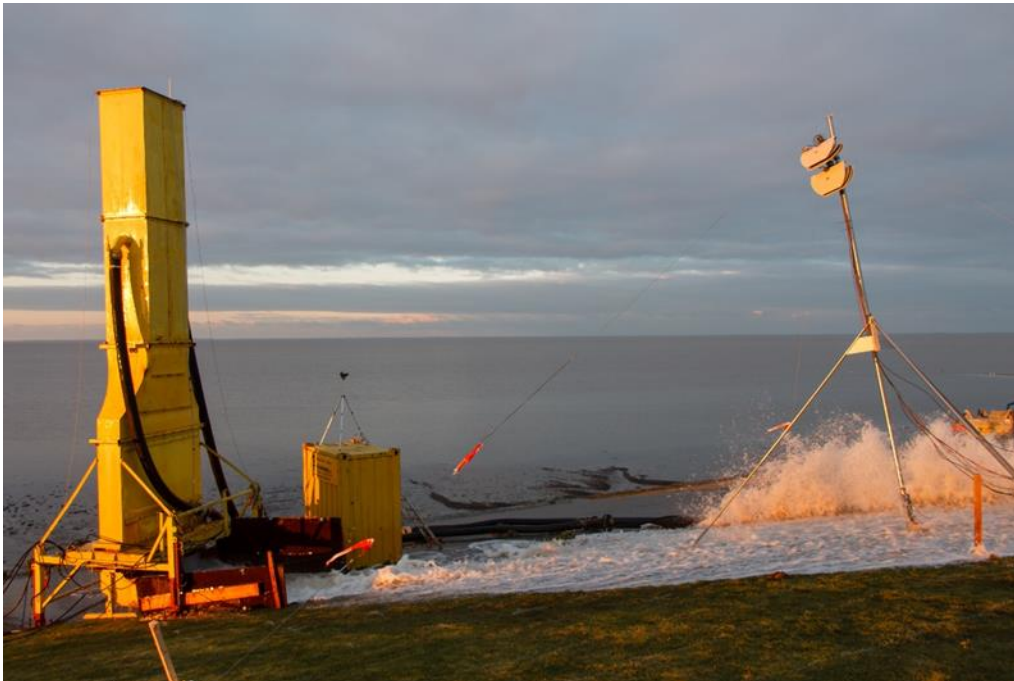
Fig. 1. Kalibratie van de laserscanners (rechts) met behulp van de golfoploopsimulator (links).
